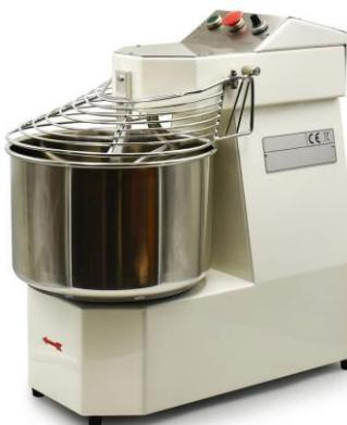
Impastatrice a spirale modello SM15 fissa INVERTER con carpenteria in acciaio **INOX 304**; dotata di utensile a spirale, vasca, piantone “spacca impasto” e protezione vasca in acciaio INOX adatte per il contatto alimentare, resistente alle più forti sollecitazioni.
